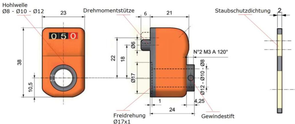
Das Gerät über die Hohlwelle setzen und darauf achten, dass die Drehmomentstütze in der vorhandene Ø 6 mm Bohrung eingesetzt wird. Den Anzeigewert auf die Ausgangsposition (Null) stellen und mit dem Gewindestift sichern.
